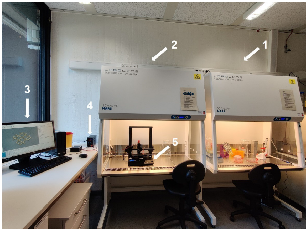
Abbildung 34: Aufbau Zelllabor für den 3D-Druck von zellbeladenen Hydrogel-Konstrukten mit 1) LAF-1 für die Vorbereitung der Zellen, 2) LAF-2 für den 3D-Druck der zellbeladenen Hydrogele, 3) Steuerung des 3D-Drucks, 4) Kontrolle der Temperatureinheit und 5) 3D-Drucker mit eingebautem Druckkopf und Temperatureinheit.
